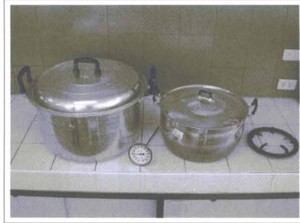
(1) หม้อ 2 ชั้น เทอร์โมมิเตอร์ ขาดังหม้อ สำหรับผลิตเครื่องตีที่ไม่สามารถให้ความร้อนสูงได้
