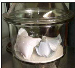
โถแก้วที่มีบรรจุภัณฑ์อ่อนตัวที่บรรจุอาหารแล้ว และทำการดูดอากาศออก
