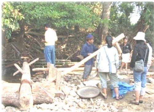
รูปที่ 83-84 ครกกระเดื่องตำข้าวโดยใช้พลังงานน้ำ
