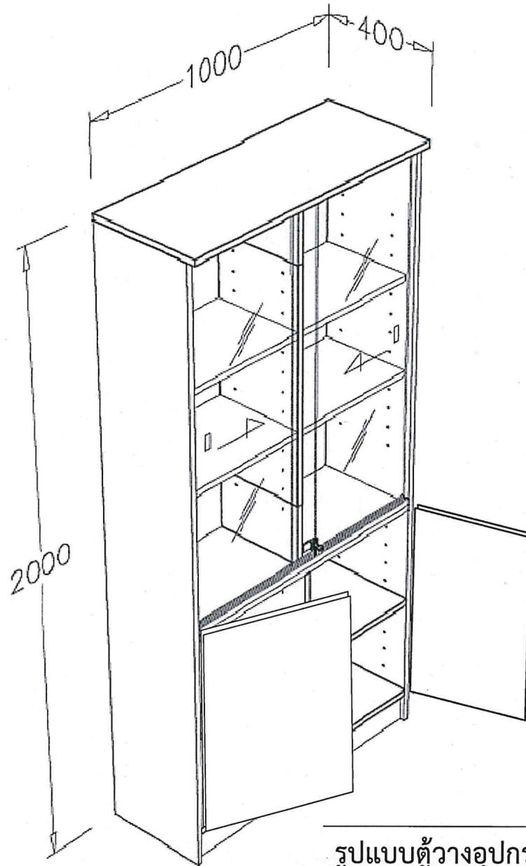
รูปแบบตู้วางอุปกรณ์ CC พร้อมติดตั้ง
